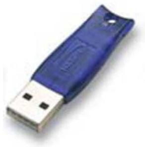
После инсталляции программного обеспечения в HASP<sup>®</sup>-ключе включится красная подсветка встроенного светодиода, что означает, что ключ установлен правильно и доступ к программе разрешен.
